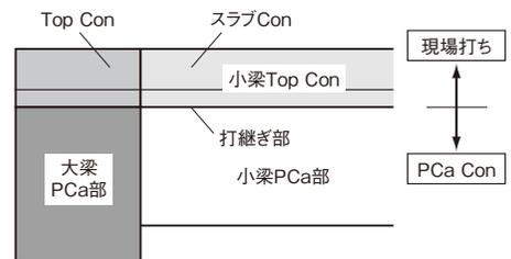
図5 PCa小梁接合部コンクリートの打ち分け
