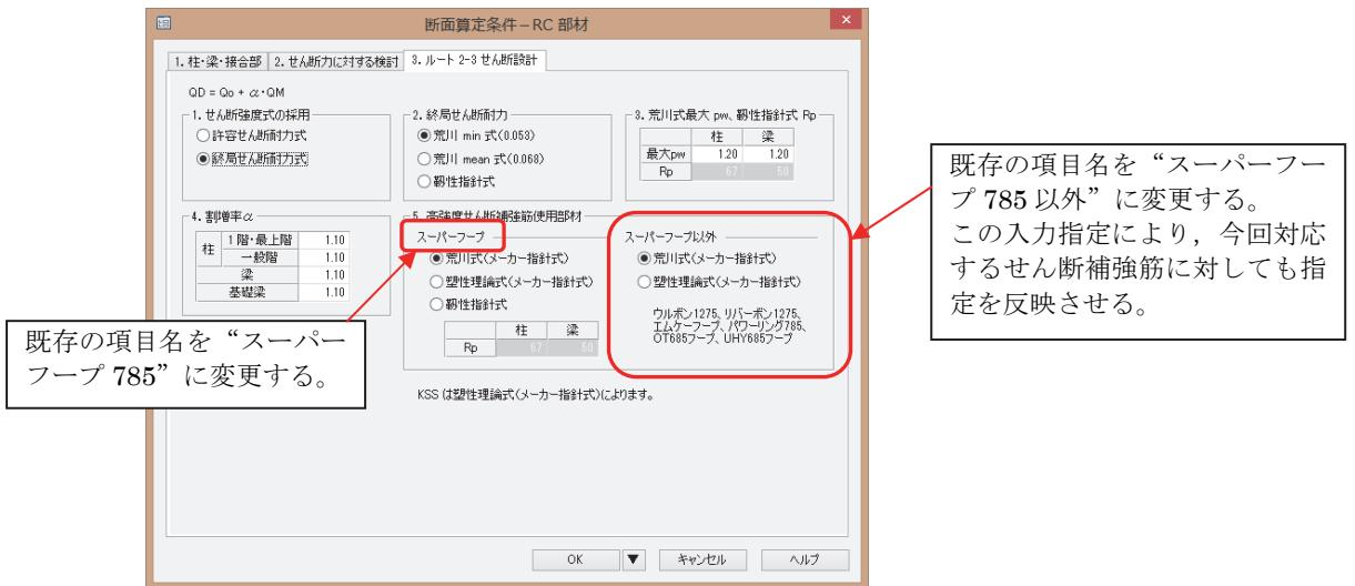
○ [2.8 終局耐力計算条件－3 RC 終局耐力－10.高強度せん断補強筋使用部材]
