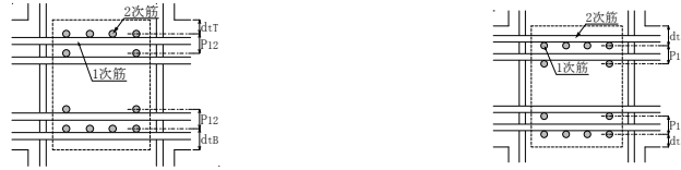
(a) 1段筋が上側(2次筋)の場合 (b) 1段筋が下側(1次筋)の場合
